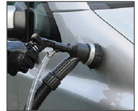
▶ Sandstrahlmittel wird nach dem Auftreffen auf die Oberfläche sofort wieder abgesaugt und zurückgeführt
