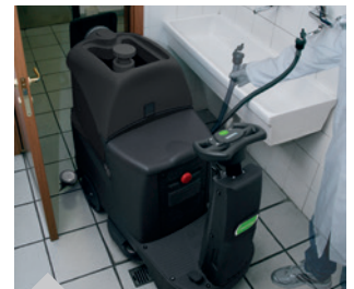
Frischwassertank mit Schlauch für Schnellbefüllung
