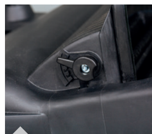
Einfache und werkzeuglose Höhenverstellung der Kehrwalze
